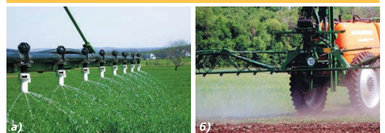
Рис. 9. Форсунки: а) струйная; б) дефлекторная (Lechler-Германия и др. фирм)
