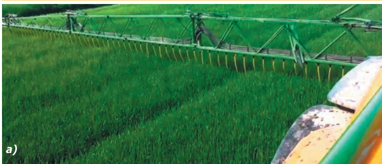
Рис. 10. Шланги удлинители на опрыскивателях: а) одинарные, расстановка - 50 см; б) спаренные, расстановка - 25 см.
