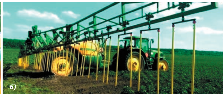
Рис. 10. Шланги удлинители на опрыскивателях: а) одинарные, расстановка - 50 см; б) спаренные, расстановка - 25 см.
