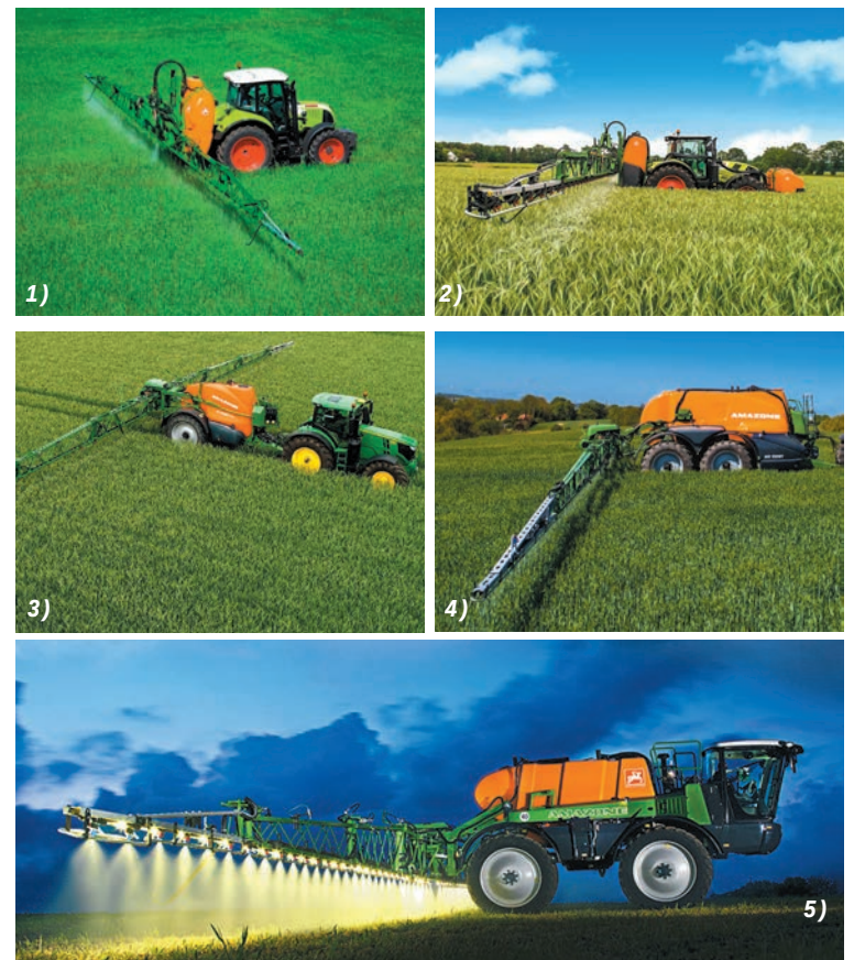
1) навесной UF; 2) комбинированный UF 2002; 3) прицепной UX 5200; 4) – самый большой UX 11200; 5) – самоходный Pantera – SX 4000
