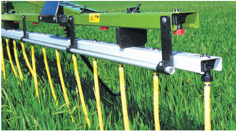
Рис. 4. Подкормка опрыскивателем с удлинительными штангами
