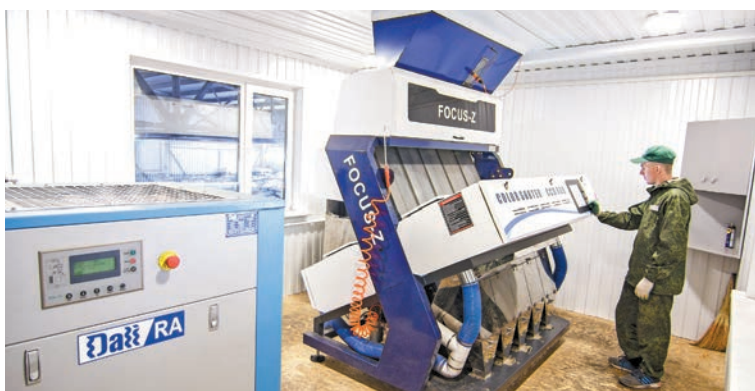
Линия очистки семян с использованием оптического сортировщика позволяет добиваться 99,9% чистоты продукта.
