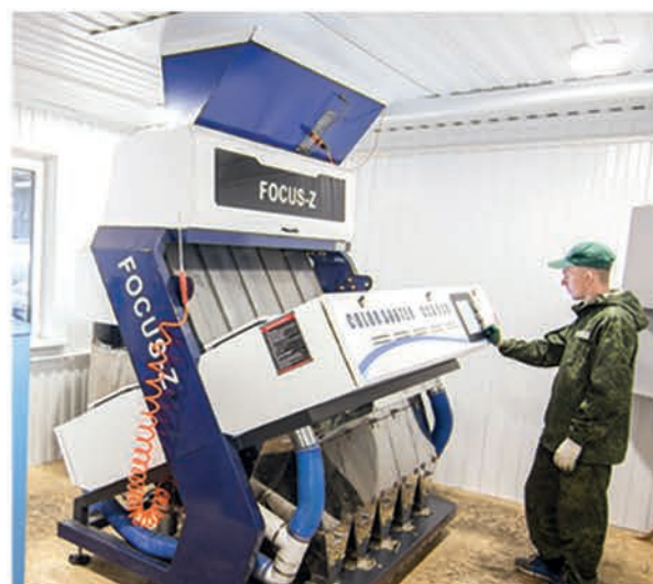
Работают две линии очистки семян с использованием оптических сортировщиков, которые позволяют добиваться чистоты продукта 99,9 %.
